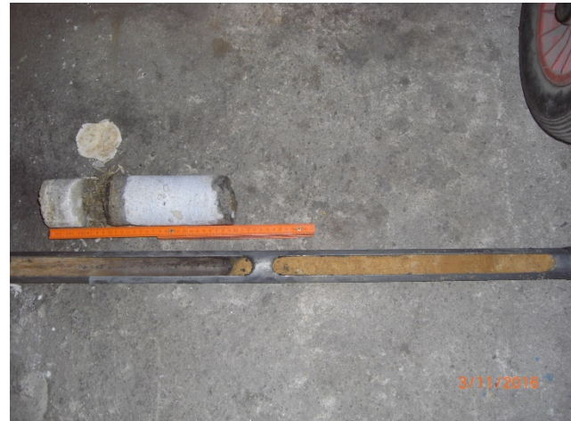
Bild 4: Detailaufnahme KRB 3/16. Die Betonmächtigkeit (mit Sperrschicht) beträgt 30 cm.
