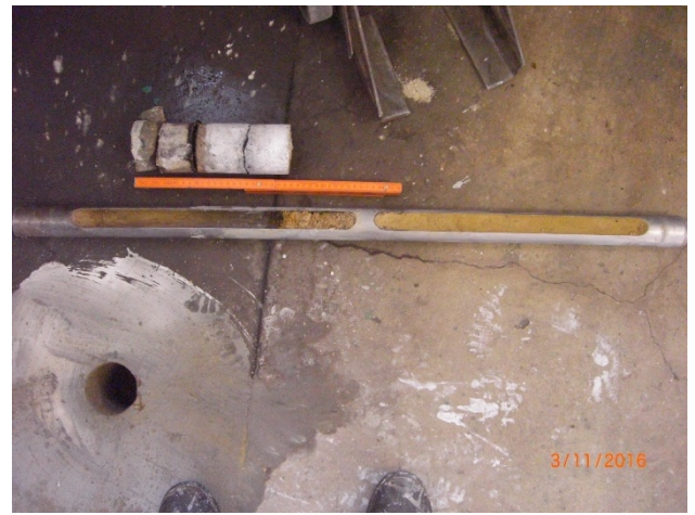
Bild 2: Detailaufnahme KRB 2/16. Die Betonmächtigkeit (mit Sperrschicht) beträgt 25 cm.
